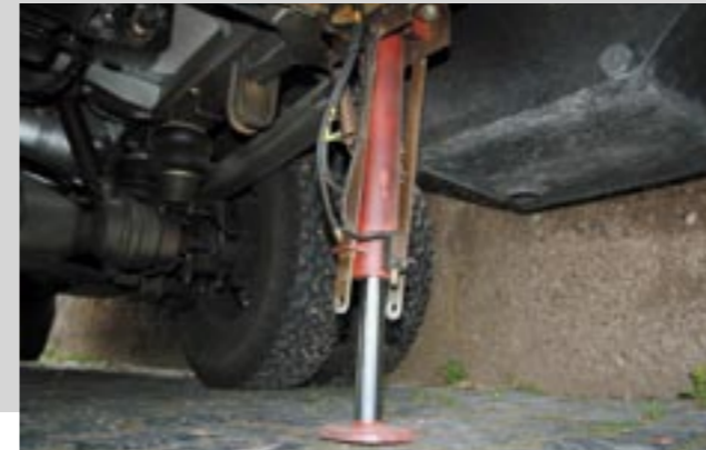
Zusatzluftfederung der Hinterachse. Automatische Ausnivellierung des Fahrzeugs mittels vier Hydraulikstempel.
